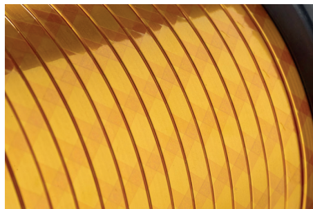
Aluminiumblankdraht flach, 2 x gegenläufig gewickelt mit SynTherm® H, 25 % Überlappung
